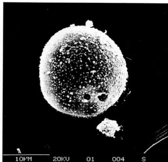
Una particella residuo di sparo fotografata in elettroni secondari al microscopio elettronico a scansione.
